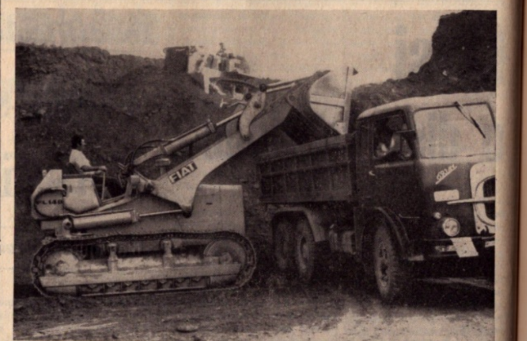
Caricatore cingolato Fiat FL 14B, potenza 160 CV, peso kg 16.400
