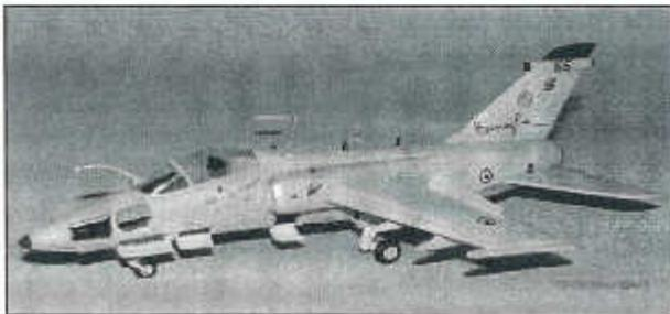
L'AMX è dotato di due piloni subalari per ogni ala e di un pilone ventrale. I piloni subalari esterni possono trasportare carichi fino a 1000 libbre (circa 450 kg) e quelli interni carichi fino a 2000 libbre (circa 900 kg) e sono tutti in grado di utilizzare serbatoi subalari sganciabili. Il pilone centrale di fusoliera può trasportare carichi fino a 2000 libbre. Sui piloni interni e sul centrale di fusoliera possono essere installati dei raddoppiatori di carichi, denominati Twin Store Carrier.
