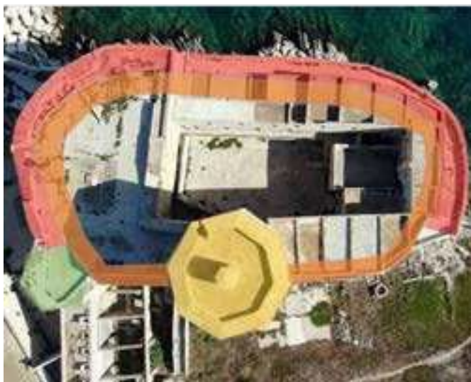
Fig. 6 La singolare struttura castellare ellittica della Colombaia databile con ogni probabilità al XIV secolo e poi rifoderata nel XVI secolo (rosso).
