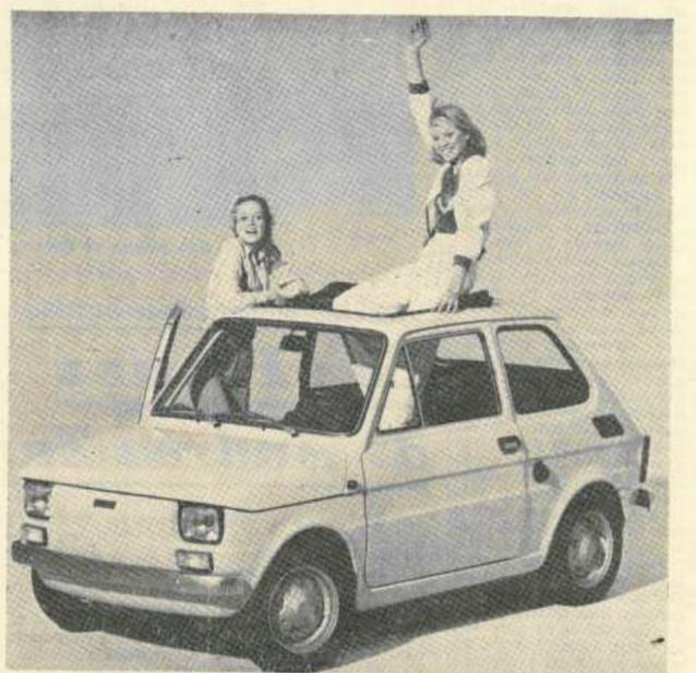
Il tetto apribile, semplice e pratico, è costituito da una copertura pieghevole, che si apre e si chiude con un unico movimento. L'apertura del tetto (686 per 860 mm.) è munita di una guarnizione esterna di gomma, mentre il padiglione è irrigidito internamente da una struttura perimetrale scatolata nella quale è incassato il gancio di chiusura del tettuccio.
