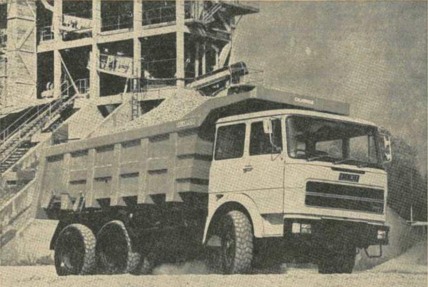
Il Gruppo Veicoli Industriali Fiat arricchisce la gamma dei suoi autocarri pesanti con il nuovo modello 300, un veicolo altamente specializzato, del tipo 6x4 (tre assi, di cui due motori), studiato appositamente per gli impieghi più gravosi in cava ed in cantiere.
