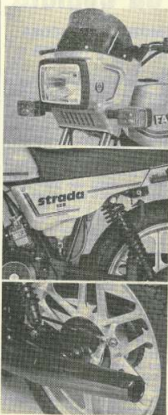
Dall'alto in basso: Gruppo portafarore, proiettore rettangolare e indicatori di direzione; sella e serbatoio; silenziatore di scarico
