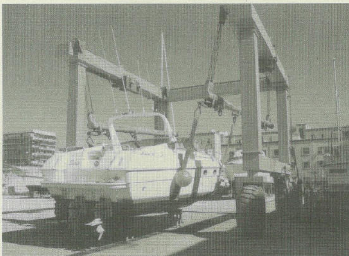
Motoscalo da 50 tonnellate che consente un rapidissimo alaggio
