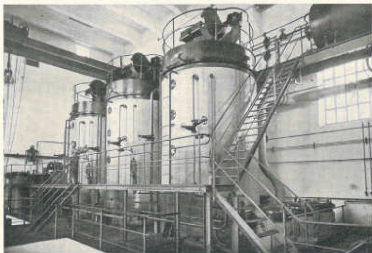
22 — R. Salina di Volterra - Apparecchi evaporatori per la produzione del sale.
