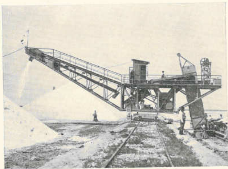
36 — R. Salina di Margherita di Savoia - Raccolta del sale - Altro tipo di elevatore meccanico.
