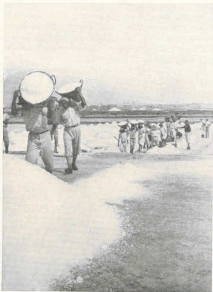
55 — Le saline di Trapani - Il sale dopo di essere stato messo a sgottare nei cumuletti conici delle caselle salanti viene ammonticchiato sulle aie.
