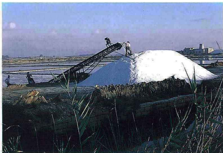
22. Marsala. Salina Ettore: attrezzo meccanico usato per ammucciare il sale
