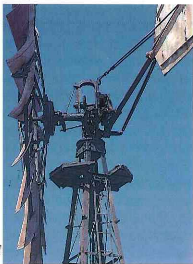
38. Ingranaggi del mulino americano
