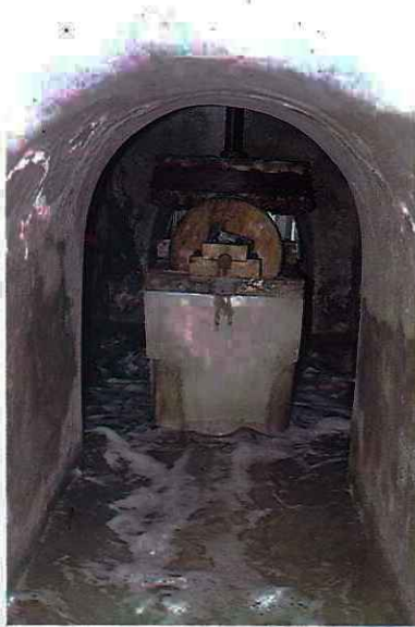
40. Interno del mulino americano: «cammara da spira», da cui defluisce l'acqua nelle vasche
