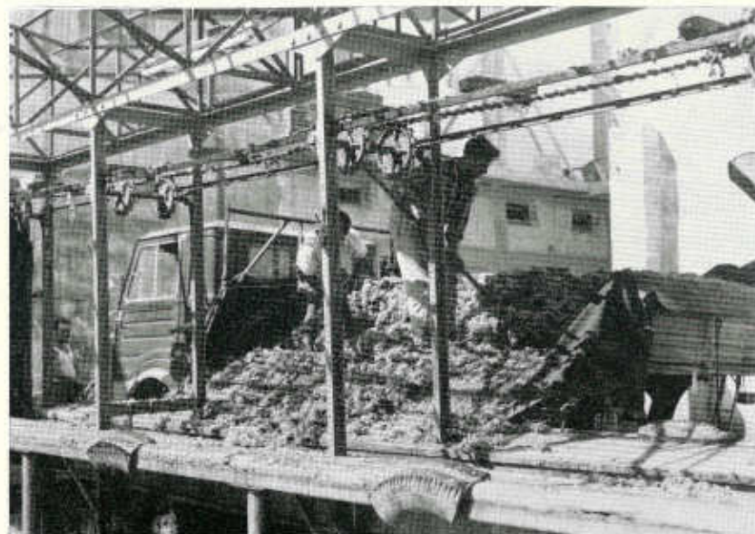
Nastri trasportatori nella Cantina Sociale «Produttori Vinicoli Riuniti» di Mazara. La capacità lavorativa delle due catene raggiunge i 600 quintali di uva in un'ora.
